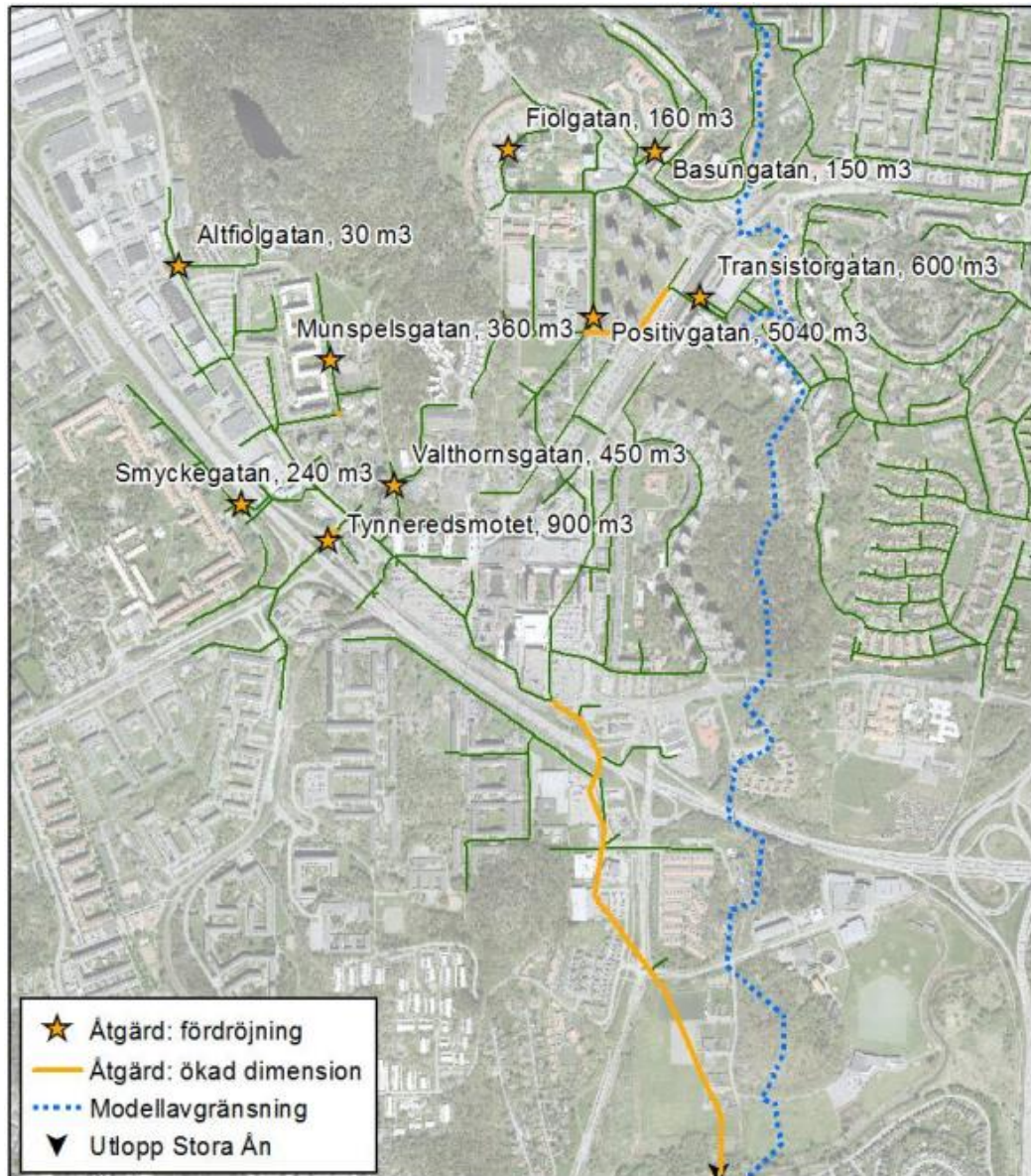
Figur 7. Översikt av åtgärdsförslag. Gula stjärnor markerar föreslagen plats för fördröjning. gula ledningar visar ledningar som har föreslagits ökade dimensioner. (Slutrapport Västra Frölunda, 2017)
